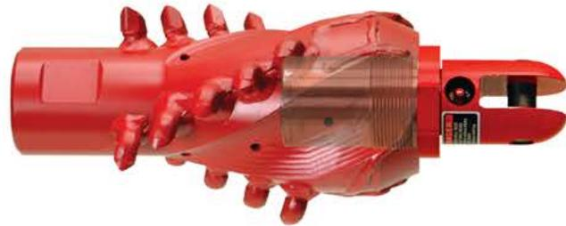
Las cargas de empuje y tracción son absorbidas por cojinetes de contacto angular de calidad premium
