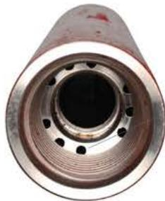
Varios conductos para fluidos permiten el flujo máximo sin restricciones de presión
