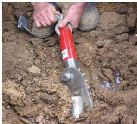
La característica de guía y tornillo, exclusiva de las cuchillas Borzall, garantiza que el accesorio giratorio permanezca alineado con la línea central de rotación de la broca
